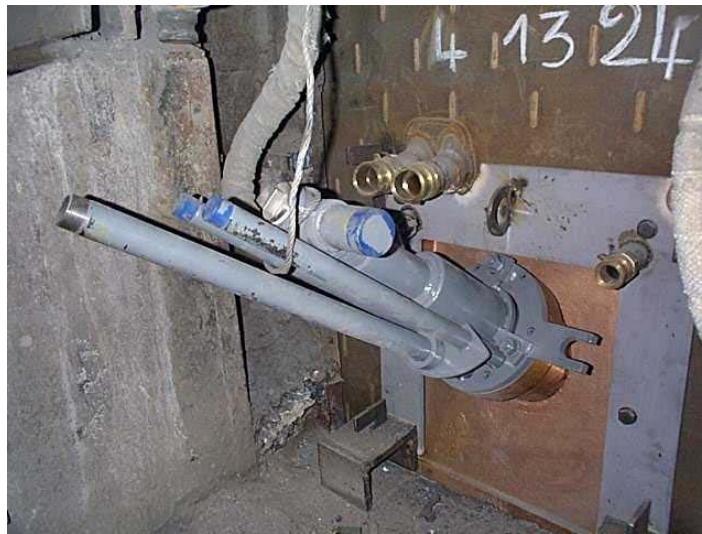
Fig 4 : PYREJET implementation on the EAF
